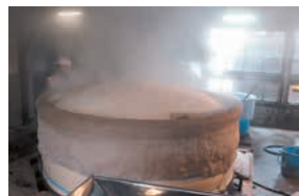
Le "Jomai", l'étape de la cuisson à la vapeur du riz. Grâce aux enseignements de Hiroshi Uehara, la cuisson uniforme du riz est améliorée en intensifiant la vapeur.
