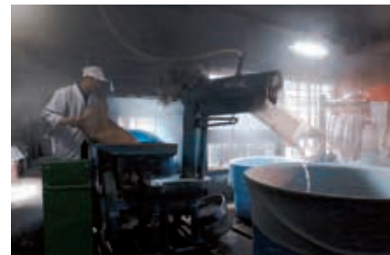
Nettoyage du riz poli, pour enlever les derniers restes de son de riz. On parle de second polissage du riz, c'est une étape qui a une sensible influence sur la qualité du saké.
