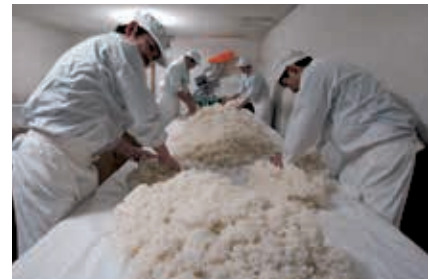
On insère le Tane-Koji dans le riz encore chaud dans la salle de préparation du Kome-Koji. Pendant cette étape la température et le taux d'humidité sont constamment contrôlés et régulés.
