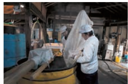
On mélange le levain, le Kome-Koji, de l'eau et le reste du riz cuit à la vapeur dans le bac de fermentation. Ce mélange appelé "Moromi(le Moût de riz)" est fait en 3 étapes successives, en ajoutant à chaque fois chacun des ingrédients.
