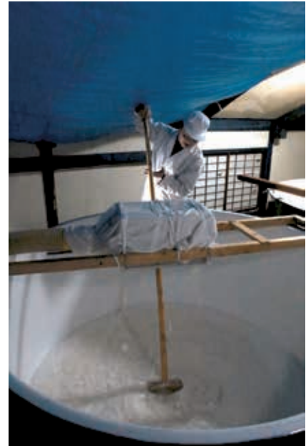
Pendant la fermentation la température du mélange est contrôlée plusieurs fois par jour. Le goût caractéristique de la brasserie Koikawa commence à se développer.
